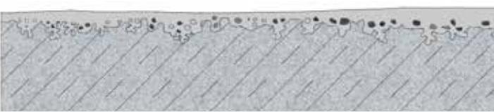
Sollte es nötig sein, große Flächen für eine Beschichtung vorzubereiten, ist das Kugelstrahlen die erste Wahl. Bei dieser Methode wird zunächst die oben liegende, mindere Qualität abgetragen. Instabile Teile werden entfernt.
