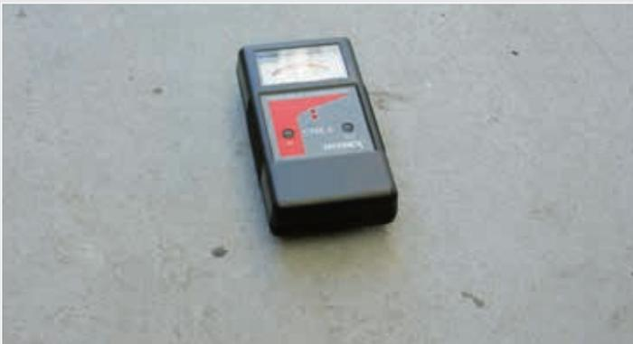
2. Der Untergrund darf zum Zeitpunkt der Beschichtungsarbeiten **maximal 5% (bezogen auf Masse; Beton) respektive 16% (bezogen auf Volumen; Holz)** Feuchtigkeit aufweisen. Mittels elektronischer Messmethoden kann dies hinreichend präzise und dabei zerstörungsfrei mit entsprechend hochwertigem Messgerät, bis zu einer bestimmten Tiefe ermittelt werden. Eine präzisere, von der Schichtstärke unabhängige Methode, ist das „CM-Verfahren“.
