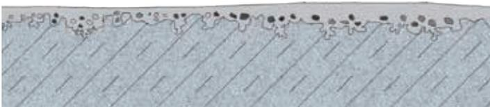
Zementschlämme und nachträglich eingebrachte Verschmutzungen bilden einen flächigen haftvermindernden bzw. -verhindernden Trennfilm. Dieser muss zwingend vor Applikation der flüssigen Harze entfernt werden.
