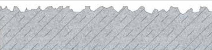
Es entsteht eine Rauheit mit relativ gleichmäßiger Oberflächentextur, die einen wesentlichen Beitrag zur Haftung leistet. Auch Poren, die nur noch eine sehr dünne Deckschicht haben, werden beim Kugelstrahlen aufgeschlagen.
