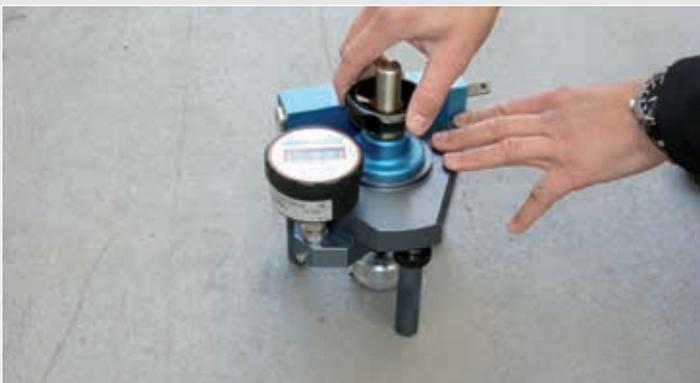
3. Voraussetzung für einen langfristigen Verbund zwischen Beschichtungsmaterial und Untergrund ist eine ausreichende Haftzugfestigkeit. Für **Betonuntergründe** sollte eine **Festigkeit von >1,5 N/mm<sup>2</sup>** und für **Asphaltuntergründe >0,8 N/mm<sup>2</sup>** erreicht werden
