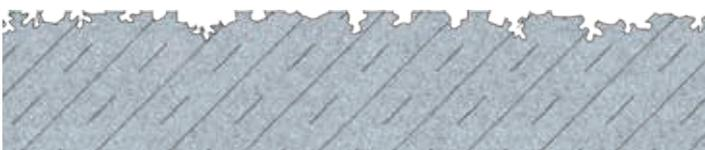
Durch das Schleifen mit einem Schleiftopf in Kombination mit einer entsprechenden Absaugung, wird der dünne Film an der Oberfläche entfernt. Die in den Poren liegende Verschmutzung wird in weiten Teilen abgesaugt.
