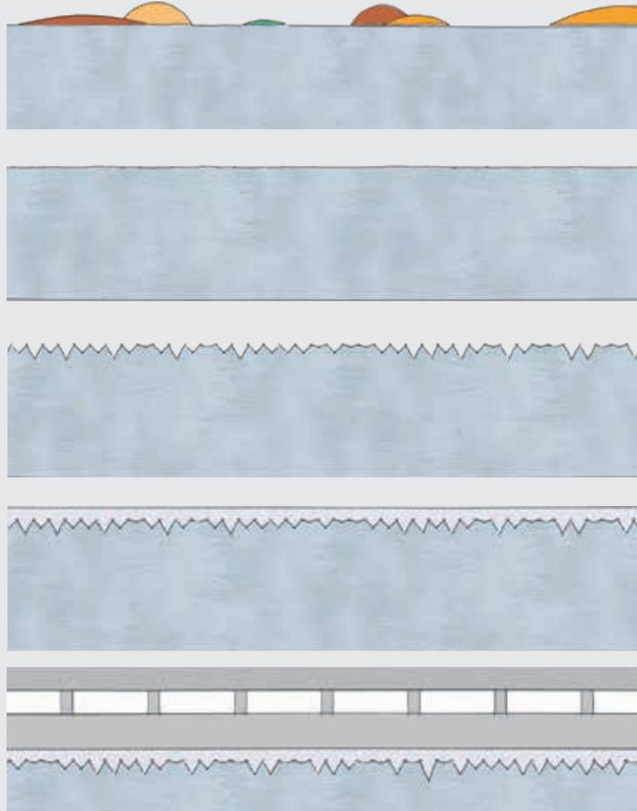
Um die bestmögliche Verbindung zwischen Harz und Untergrund zu gewährleisten, ist das gründliche Reinigen des jeweiligen Untergrundes mit einem auf das System abgestimmten Reiniger erforderlich. Dies sorgt dafür, dass Trennmedien wie z. B. Staub, Fette und andere typische Substanzen, die in keiner direkten Verbindung mit dem Untergrund stehen, entfernt werden.
